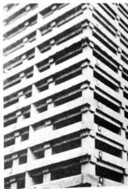
construcción (foto 5) se aprecia la absoluta incoherencia entre la pesada tecnología real de hormigón aplicada para contrarrestar los terremotos chilenos, y la apariencia estética de un curtain wall “de delicado acero y cristal”
